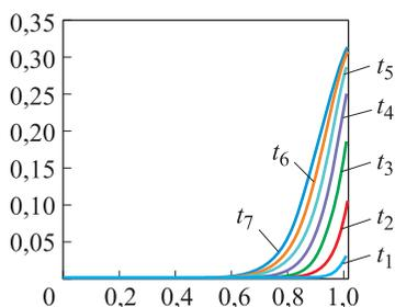
**Рис. 7.** Распределение концентрации пиролитической фазы  $\phi_b$  композита по безразмерной координате  $x$  в контрольной точке оболочки в различные моменты времени полета ГЛА
