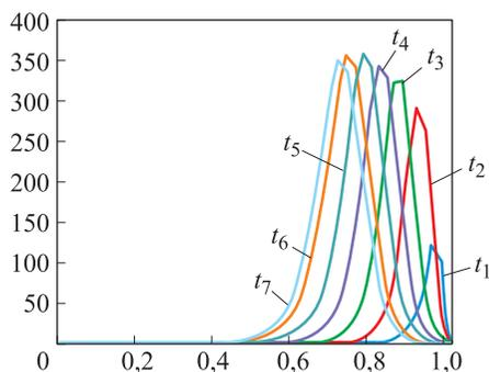
**Рис. 10.** Распределение порового давления  $p$ , атм, газообразных продуктов терморазложения полимерной фазы  $\varphi_p$  композита по безразмерной координате  $x$  в контрольной точке оболочки в различные моменты времени
