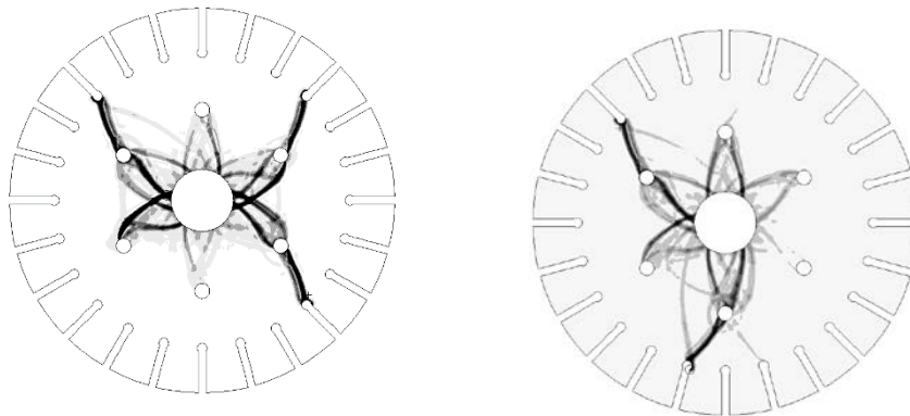
Рис. 10. Формы разрушения модельного диска при моделировании разгонных испытаний
