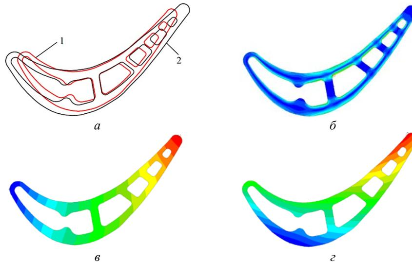
**Рис. 5.** Результаты расчета термонапряженного состояния сечения лопатки: а – начальная (1) и деформированная (2) геометрия; б – распределение интенсивности напряжений; в – распределение перемещений в направлении оси X; г – распределение перемещений в направлении оси Y
