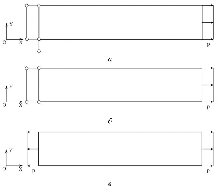
**Рис. 2.** Расчетные схемы тела под действием уравновешенной системы сил
