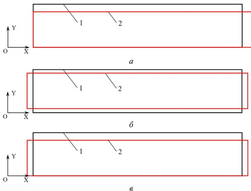
**Рис. 3.** Начальная (1) и деформированная (2) геометрия тела под действием уравновешенной системы сил
