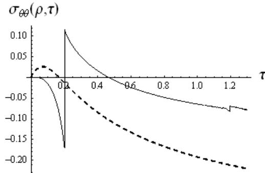
Рис. 3. Временная зависимость  $\sigma_{\theta\theta}(\rho, \tau)$  при  $\rho = 2$ ,  $\nu = 0.25$ : — динамическая кривая при  $\gamma = 0.2$ ; ---- квазистатическая кривая при  $\gamma = 0$
