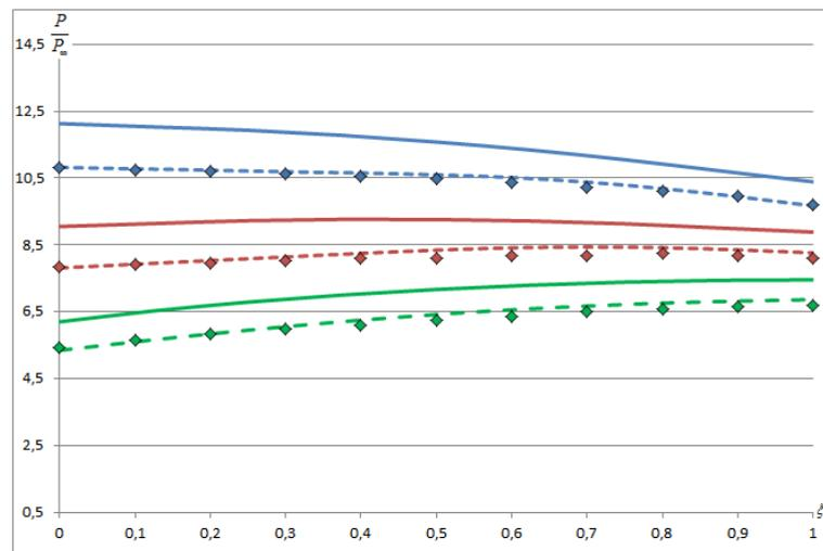
**Рис. 3.** сравнение распределения давления в возмущенной области около сферы на различных лучах. Сплошная линия – распределение давления для совершенного газа [19], пунктирная линия – распределение давления с использованием предлагаемой зависимости, ромбы – данные из [9]:
