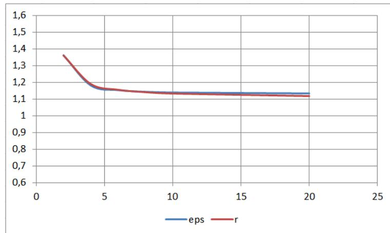
**Рис. 10.** Отход ударной волны от тела на критической линии в долях радиуса обтекаемой сферы:
