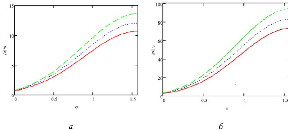
**Рис. 1.** Распределение давление вдоль поверхности сферы при различных показателях адиабаты, синяя -  $\gamma = 1,4$ , красная -  $\gamma = 1,18$ , зеленая -  $\gamma = 1,66$ :
