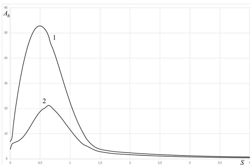
**Рис. 1.** Распределение коэффициента теплообмена  $A_h$  на холодной непроницаемой стенке по поверхности затупленного конуса;
