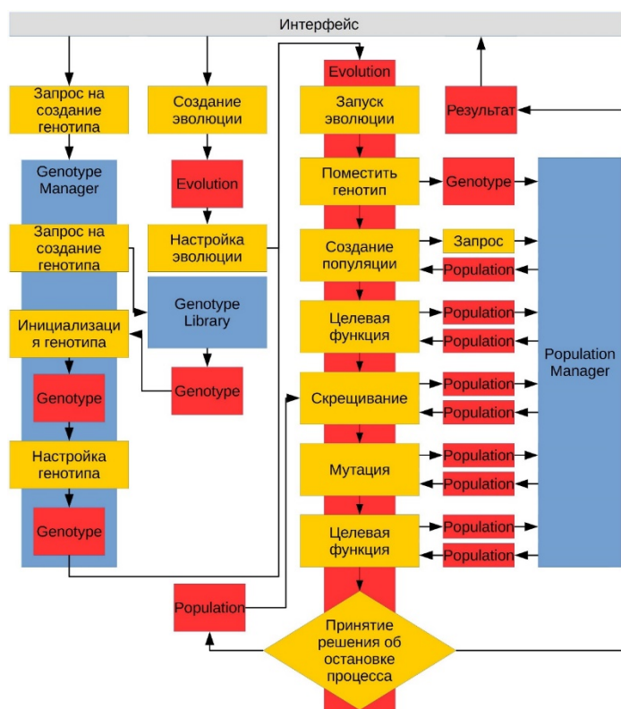
Рис. 5. Структурная схема реализованного генетического алгоритма
