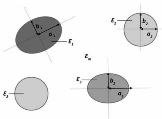
**Рис. 2.** Модель нанокompозитной среды аппроксимированных по форме частиц
