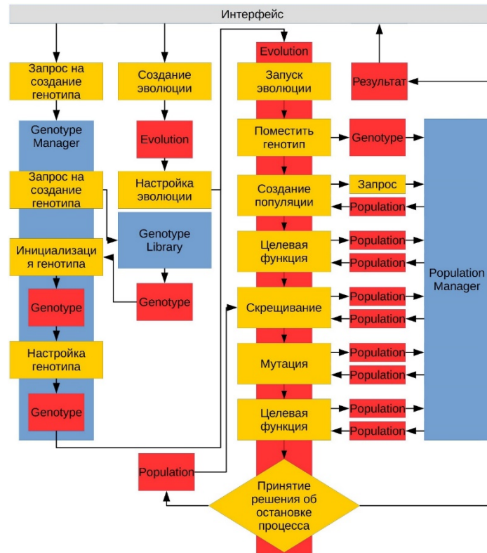
Рис. 5. Структурная схема реализованного генетического алгоритма
