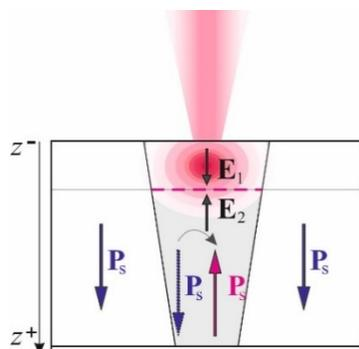
**Рис. 4.** Схематическое представление процесса электронно-индуцированного переключения доменов в  $\text{LiNbO}_3$  и  $\text{LiTaO}_3$
