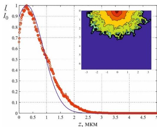
**Рис. 6.** Нормированное распределение по глубине функции потерь энергии электронами в образце LiTaO<sub>3</sub> (на вставке – двумерное представление) при параметрах:  $E_0=25$  кэВ,  $N = \tilde{N} = 5000$ ,  $d=2$  мкм
