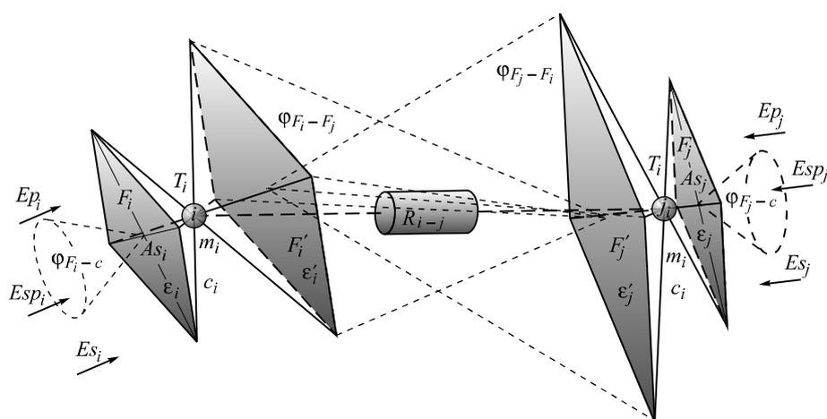
**Рис. 2.** Схема теплообмена двух произвольных тепловых узлов ( $i$  и  $j$ -го) между собой и с окружающим пространством
