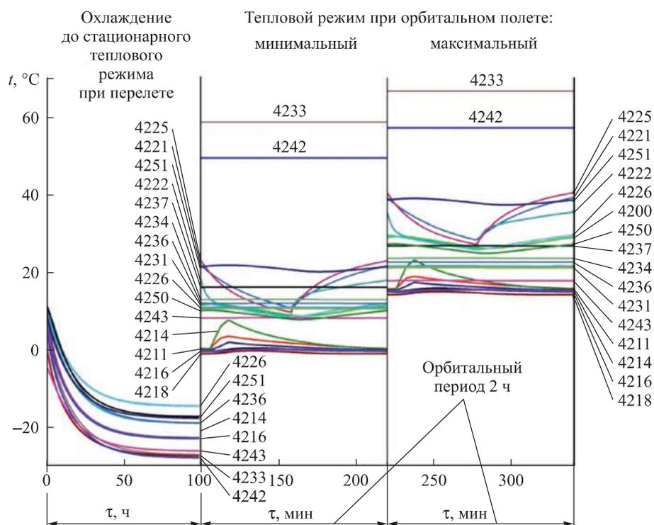
**Рис. 7.** Результаты математического моделирования температуры тепловых узлов модели АЦС на различных стадиях полета EхoMars
