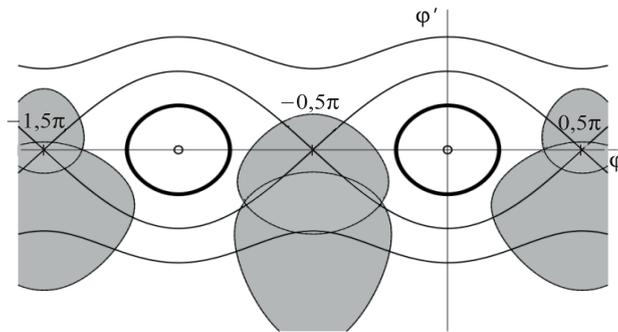
Рис. 4. Колебания вокруг устойчивых равновесий
