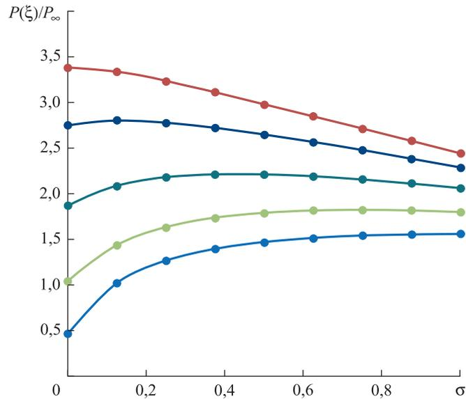
**Рис. 1.** Распределение давления при  $M = 1,5$  и значениях центрального угла  $\sigma$ :
