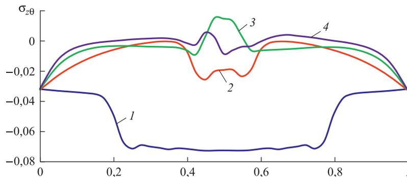
**Рис. 3.** Зависимость напряжения  $\sigma_{z0}$  от координаты в момент времени  $t = 0,8$  при  $M_1 = M$ ;  $\rho'_1 = 1500$ ,  $\Omega = 1$  и следующих значениях скорости жидкости:
