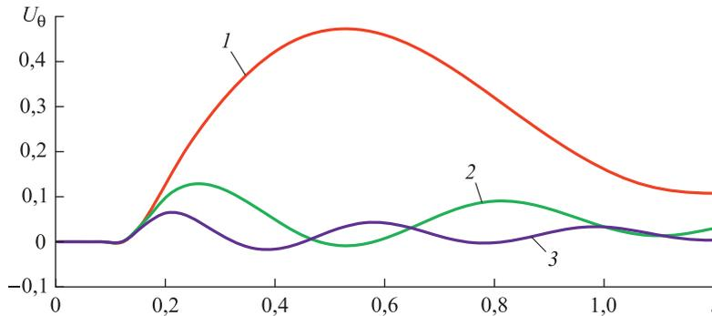
**Рис. 2.** Зависимость перемещения  $U_\theta$  от времени в сечении  $z = 0,1$  вращающейся буровой колонны при  $M_1 = M$ ;  $\rho'_1 = 1500$ ,  $\Omega = 1$  и следующих значениях скорости жидкости:
