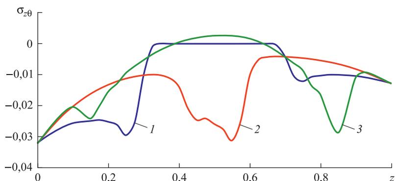
**Рис. 6.** Зависимость напряжения  $\sigma_{z\theta}$  от координаты с учетом движущейся вязкой
