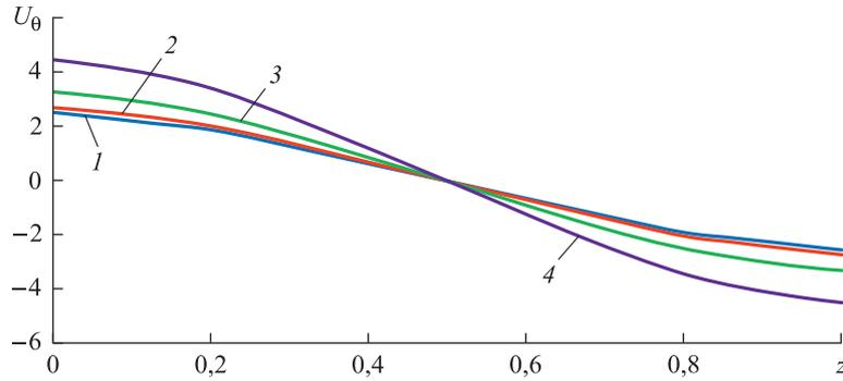
**Рис. 1.** Зависимость перемещения  $U_\theta$  от координаты в момент времени  $t = 1, 2$  при  $M_1 = M$ , отсутствии внутренней жидкости ( $\rho'_1 = 0$ ) и следующих значениях угловой скорости:
