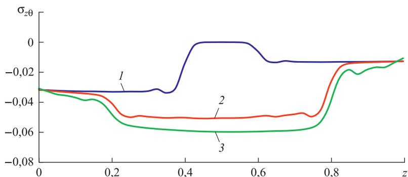
**Рис. 4.** Зависимость напряжения  $\sigma_{z\theta}$  от координаты без учета жидкости ( $\rho'_1 = 0$ )
