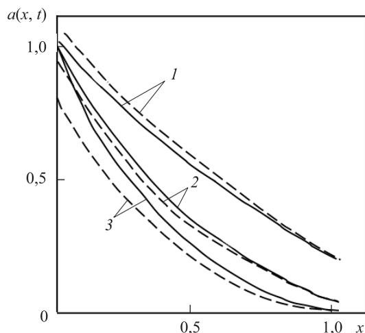
**Рис. 2.** Результаты решения МКР модельной задачи при  $t$ , равном 10 (1), 30 (2) и 60 (3):
