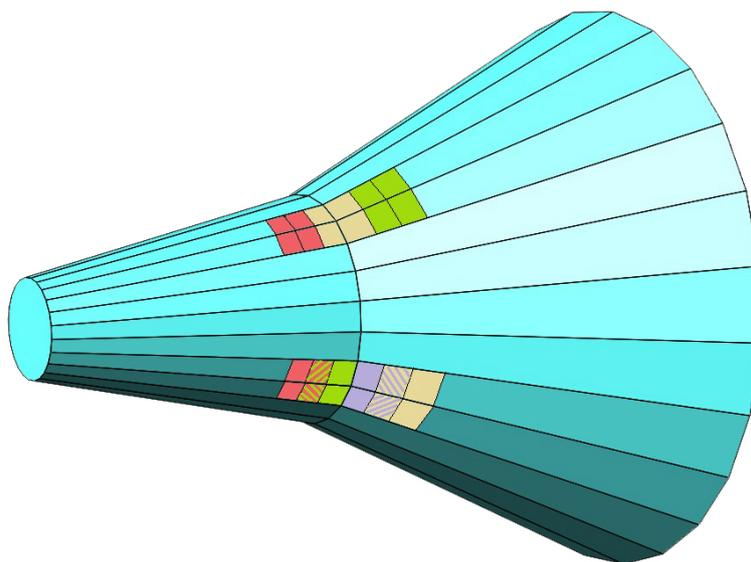
**Рис. 11.** Тело, состоящее из элементов конусов с разным углом полураствора; покрашенные ячейки, расположенные на стыке конусов, демонстрируют ошибку классификации, заштрихованные ячейки иллюстрируют способ преодоления ошибки классификации
