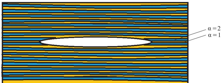
**Рис. 2.** Периодическая структура композита с дефектом типа расслоения
