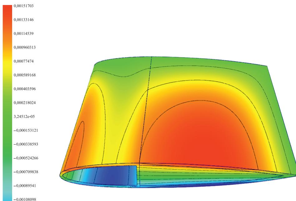
Рис. 4. Распределение поперечных перемещений  $u_2$  (м)
