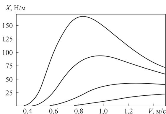
**Рис. 3.** Волновое сопротивление обтекаемого трубопровода под скачком плотности:  $H = 40$  м;  $H_1 = 10$  м;  $\rho_2/\rho_1 = 1,10$ ;  $h_i = 1,5; 2; 3; 4,5$  м
