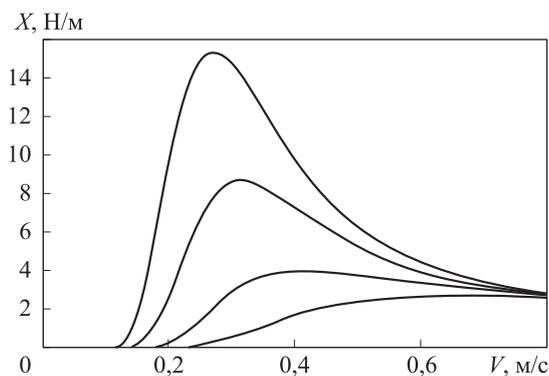
**Рис. 2.** Волновое сопротивление обтекаемого трубопровода под скачком плотности:  $H = 40$  м;  $H_1 = 10$  м;  $\rho_2/\rho_1 = 1,01$ ;  $h_i = 1,5; 2; 3; 4$  м
