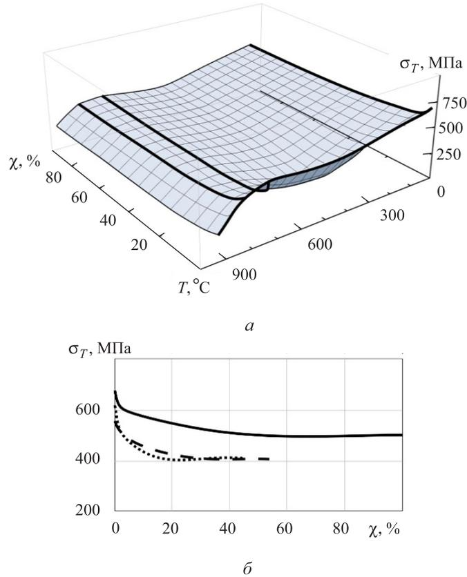
**Рис. 7.** Параметр пластичности  $\sigma_T(\chi, T)$  для сплава IN738LC в температурном диапазоне от 24° С до 950° С (а) и опорные зависимости (б) при:
