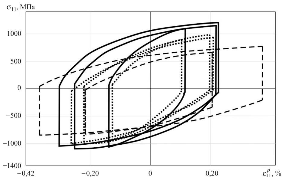
**Рис. 2.** Экспериментальные кривые деформирования циклов [10], принятых в качестве предельных для сплава IN738LC при:
