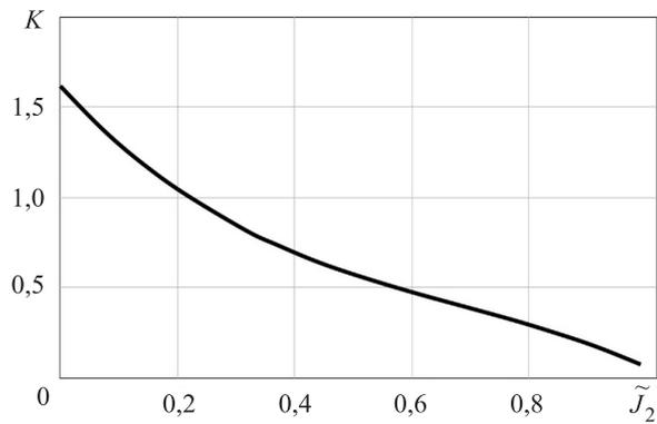
**Рис. 5.** Зависимость  $K(\tilde{J}_2)$  для никелевого сплава IN738LC
