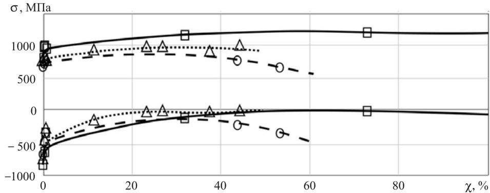
**Рис. 6.** Зависимости  $\sigma^+(\chi)$  и  $\sigma^-(\chi)$  для никелевого сплава IN738LC:
