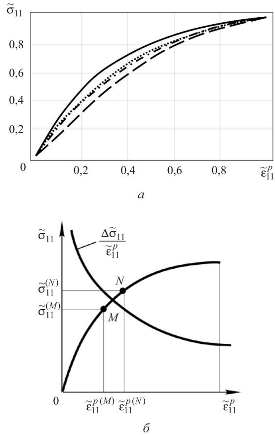
**Рис. 4.** Обезразмеренные усредненные кривые предельного цикла для IN738LC (а) и определение  $\Delta \tilde{\sigma}_{11} / \Delta \tilde{\epsilon}_{11}^p$  по усредненной кривой (б):
