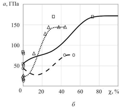
**Рис. 8.** Параметр пластичности  $a(\chi, T)$  для сплава IN738LC в температурном диапазоне от 24° С до 950° С (а) и зависимости для трех значений температур (б):
