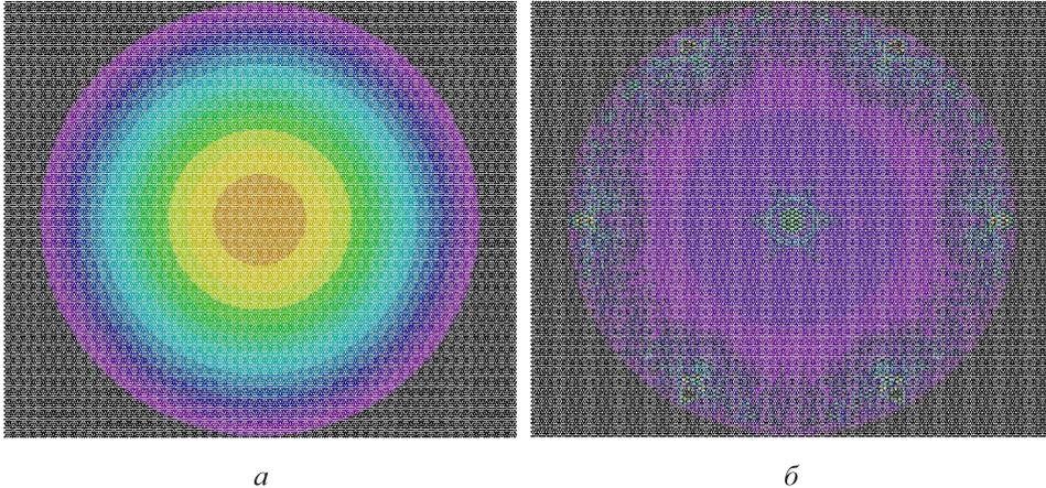
**Рис. 1.** Эффект ИГС для решения задачи о колебаниях круглой мембраны, полученный при  $R = 1$ ,  $a = 0,1$ ,  $\tau = 0,01$ ,  $\xi = 1$ , параметре схемы Кранка — Николсон  $\alpha = 0,5$  ( $\gamma \approx 0,03$ ) на 600-м ходе схемы (5) (а) и 940-м ходе схемы (3) (б); для компоненты  $u$  использована цветовая карта из статьи [3]
