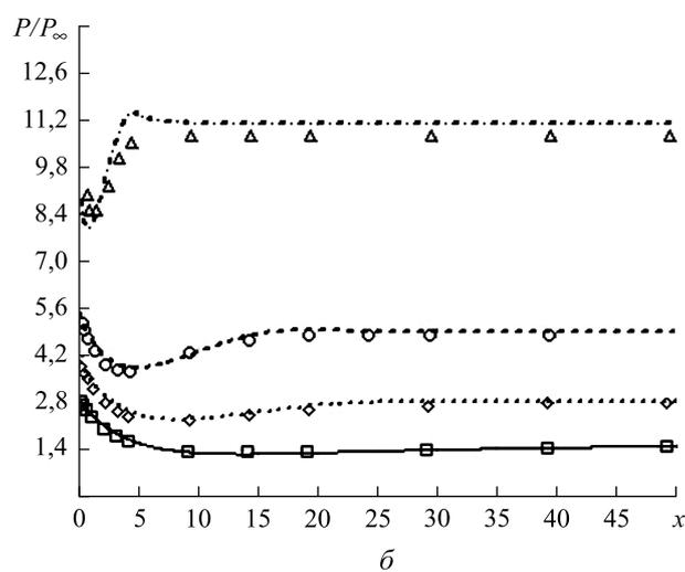
**Рис. 2 (начало).** Распределение давления  $P/P_\infty$  при  $M_\infty$ , равном 4 (а), 6 (б), при угле полураствора конуса (град): —, □ — 5; ---, ◇ — 10; ····, ○ — 15; -·-·, ▲ — 25; табличные данные обозначены маркерами, данные расчетов — линиями
