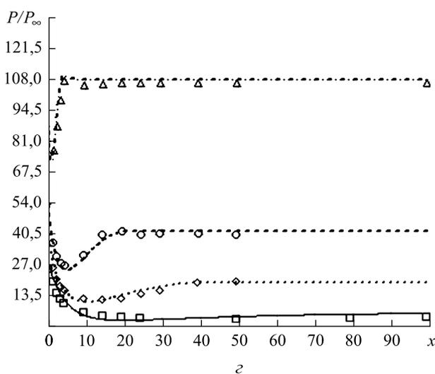
**Рис. 2 (окончание).** Распределение давления  $P/P_\infty$  при  $M_\infty$ , равном 7 (а), 20 (б), при угле полураствора конуса (град): —, □ — 5; ---, ◇ — 10; ····, ○ — 15; -·-·-, △ — 25; табличные данные обозначены маркерами, данные расчетов — линиями
