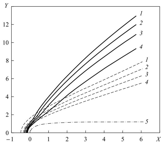
**Рис. 7.** Геометрическая форма модели и ударных волн при удалении  $D$  критической точки модели от среза сопла, равном 1,11 (1), 1,67 (2), 2,22 (3) и 3,17 (4) соответственно:
