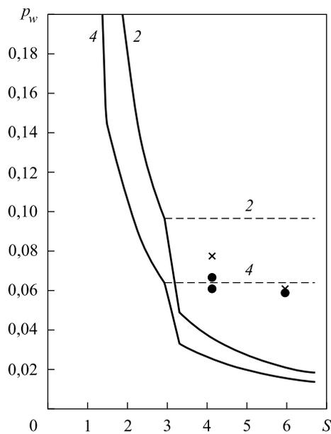
**Рис. 8.** Сопоставление расчетных и экспериментальных данных по распределению давления при удалении  $D$  критической точки модели от среза сопла, равном 1,67 (2) и 3,17 (4) соответственно:
