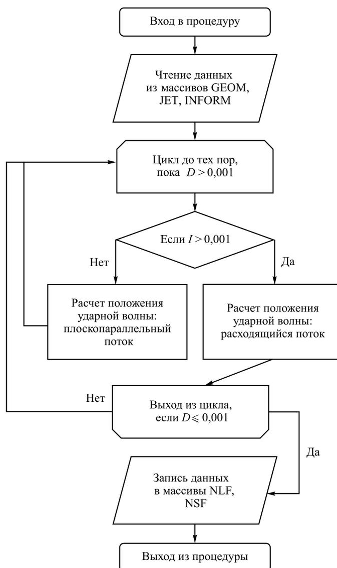
Рис. 5. Принципиальная блок-схема решения задачи:
