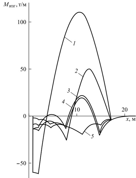
**Рис. 1.** Изменение изгибающего момента  $M_{изг}$  по длине внутренней оболочки для двух (1), трех (2), четырех (3), пяти (4) и шести (5) опор
