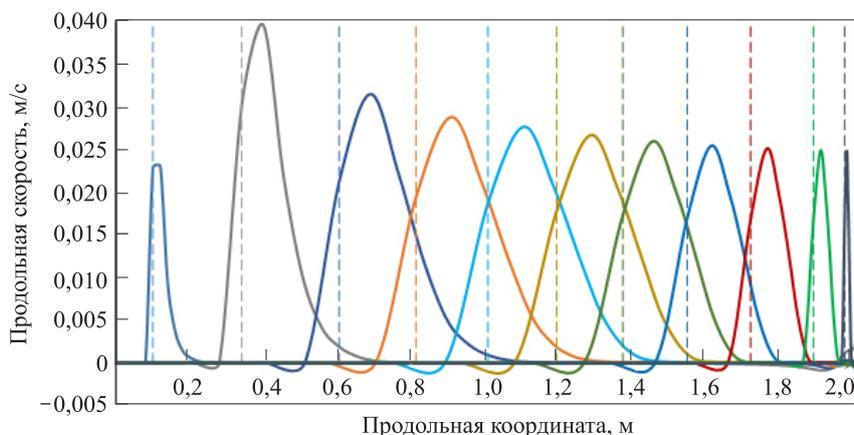
**Рис. 3.** Графики распределения средней по сечению компоненты  $\bar{v}_3$  макроскопической скорости в зависимости от продольной координаты для соответствующих положений границы раздела фаз для разных моментов времени:
