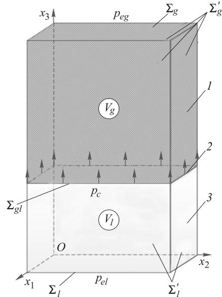
**Системы уравнений Навье — Стокса и Стокса для моделирования движения жидкости и газа в порах композита.** Под действием давления, создаваемого в пористой среде при методе RTM, происходит движение жидкой фазы по порам, при котором вытесняется газовая фаза. Общая постановка задачи движения слабосжимаемой жидкости и газа основана на системе уравнений Навье — Стокса, которая в безразмерной форме имеет вид [21]
