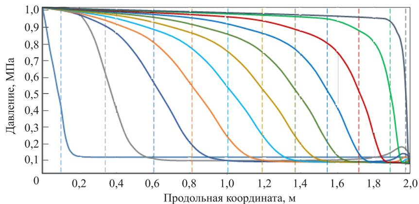
**Рис. 2.** Графики распределения среднего по сечению макроскопического давления  $p$  в зависимости от продольной координаты для соответствующих положений границы раздела фаз и разных моментов времени:
