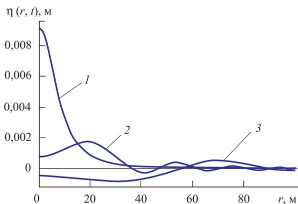
**Рис. 5.** Сечения профилей волн на ледяном покрове в зависимости от радиальной координаты в различные моменты времени  $t$  (с):
