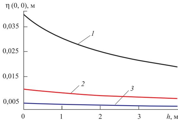
**Рис. 7.** Зависимость величины  $\eta(0,0)$  (при  $r = 0$  м) от толщины льда  $h$  при различных глубинах погружения источника  $l$  (м):
