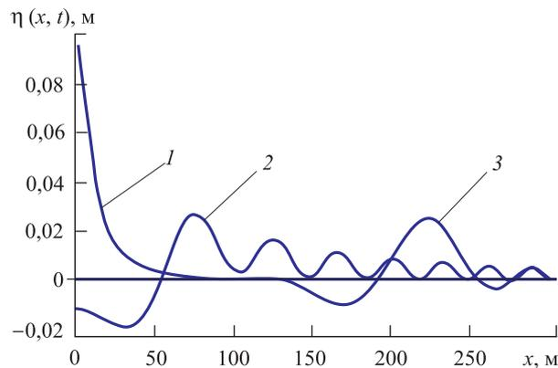
**Рис. 1.** Профили волны на ледяном покрове в зависимости от горизонтальной координаты в разные моменты времени  $t$  (с):
