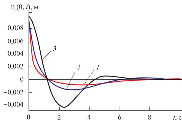
**Рис. 6.** Зависимости отклонения точки поверхности льда, находящейся непосредственно над источником (при  $r = 0$  м), от времени  $t$  при разных значениях  $h$  (м):
