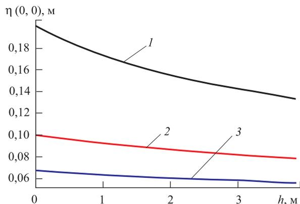
**Рис. 3.** Зависимость величины  $\eta(0, 0)$  (при  $x = 0$  м) от толщины льда  $h$  при различных глубинах погружения источника  $l$  (м):
