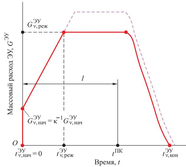
**Рис. 3.** Линейно-постоянная массорасходная характеристика энергоустройств (ЭУ) (штриховой линией показано варьирование прогрессивности ЭУ):
