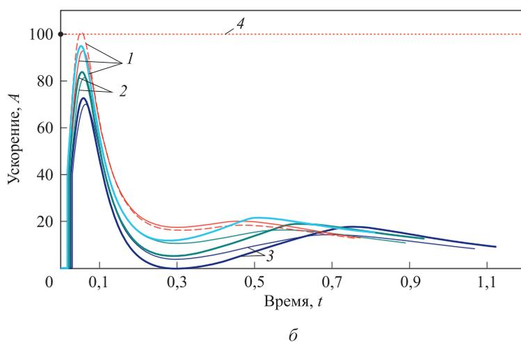
**Рис. 5.** Скорость (а) и ускорение (б) ЛА при движении в ПК: 1 — максимальный режим ( $v=+20\%$ ); 2 — номинальный режим ЭУ; 3 — минимальный режим ( $v=-20\%$ ) (штриховыми линиями обозначено  $\kappa=4$ , тонкими сплошными —  $\kappa=5$ , жирными сплошными — внутрибаллистический расчет МРХ); 4 — ограничение на максимальное ускорение ЛА
