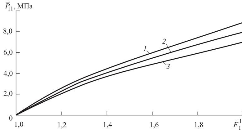
**Рис. 2.** Диаграммы деформирования  $\bar{P}_{11}(\bar{F}_1^{-1})$  для слоистого композита, построенные с помощью разработанного метода, при разных относительных толщинах  $h_2$  второго (жесткого) слоя:
