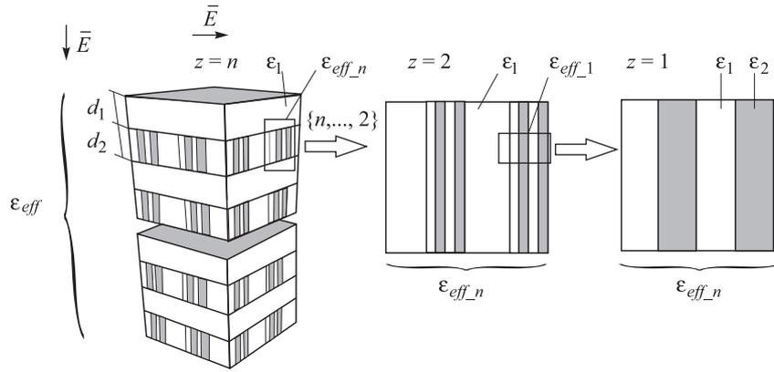
**Рис. 1.** Модель слоистого иерархически построенного композита:  $z$  — уровень фрактальности; стрелки обозначают направление вектора напряженности электрического поля  $\vec{E}$
