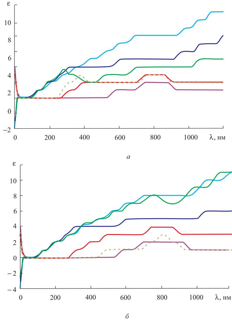
**Рис. 3.** Зависимости комплексной диэлектрической проницаемости  $\varepsilon$  от длины волны  $\lambda$  на разных уровнях фрактальности; поле направлено поперек (а) и вдоль (б) направления слоев:
