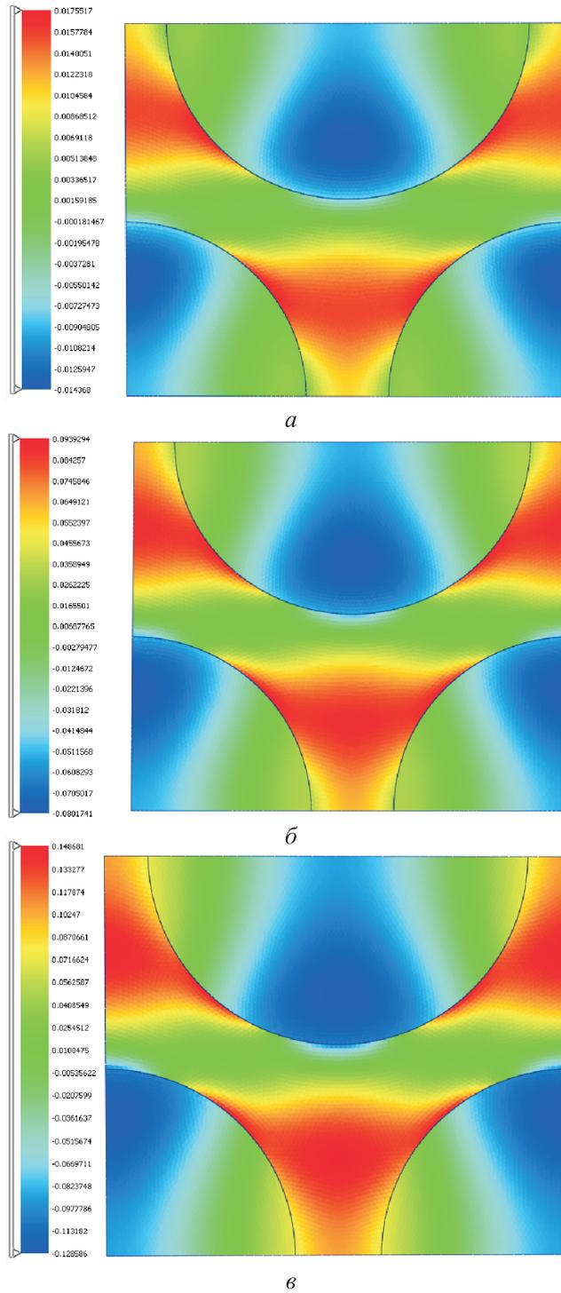
**Рис. 6.** Распределение компоненты  $\text{Im } B_{1212}(\tilde{\omega}, \xi)$  тензора концентрации напряжений  ${}^4 \mathbf{B}(\tilde{\omega}, \xi)$  в ЯП однонаправленного композита при частотах 15 (*a*), 100 (*б*), 200 (*в*) Гц
