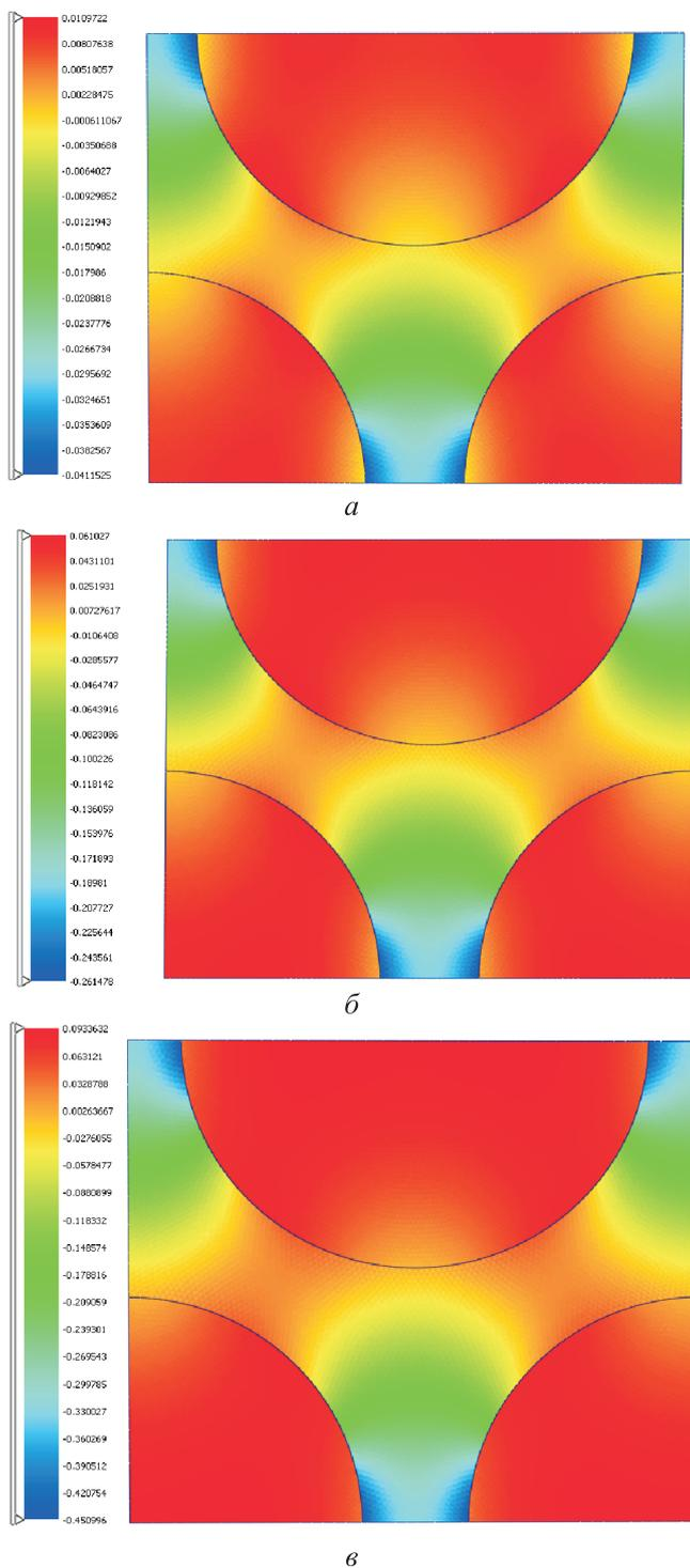
**Рис. 7.** Распределение компоненты  $\text{Im } B_{2211}(\tilde{\omega}, \xi)$  тензора концентрации напряжений  ${}^4 \mathbf{B}(\tilde{\omega}, \xi)$  в ЯП однонаправленного композита при частотах 15 (*a*), 100 (*б*), 200 (*в*) Гц
