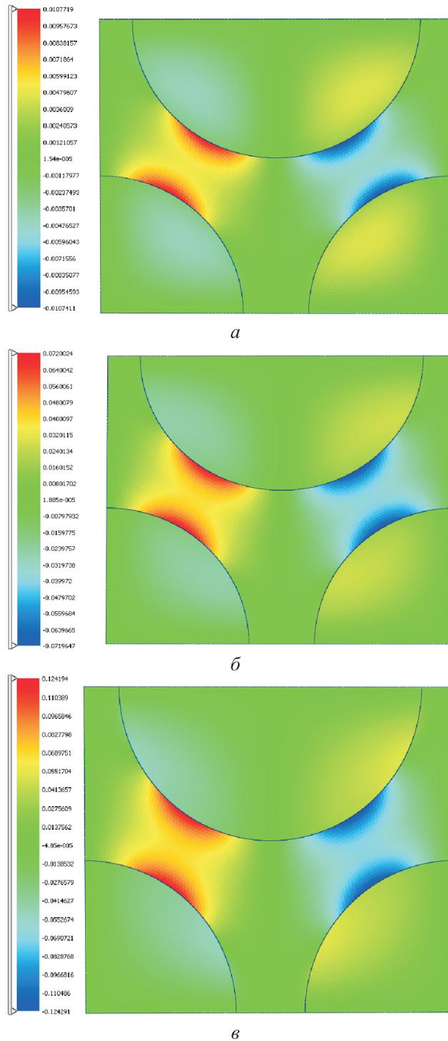
**Рис. 8.** Распределение компоненты  $\text{Im } B_{1222}(\tilde{\omega}, \xi)$  тензора концентрации напряжений  ${}^4\mathbf{B}(\tilde{\omega}, \xi)$  в ЯП однонаправленного композита при частотах 5 (*a*), 100 (*б*), 200 (*в*) Гц
