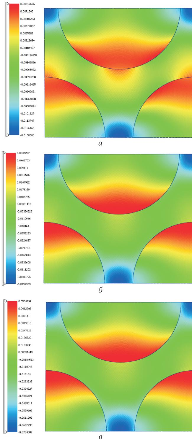
**Рис. 4.** Распределение компоненты  $\text{Im } B_{1111}(\tilde{\omega}, \xi)$  тензора концентрации напряжений  ${}^4 \mathbf{B}(\tilde{\omega}, \xi)$  в ЯП однонаправленного композита при частотах 15 (*a*), 100 (*б*), 200 (*в*) Гц
