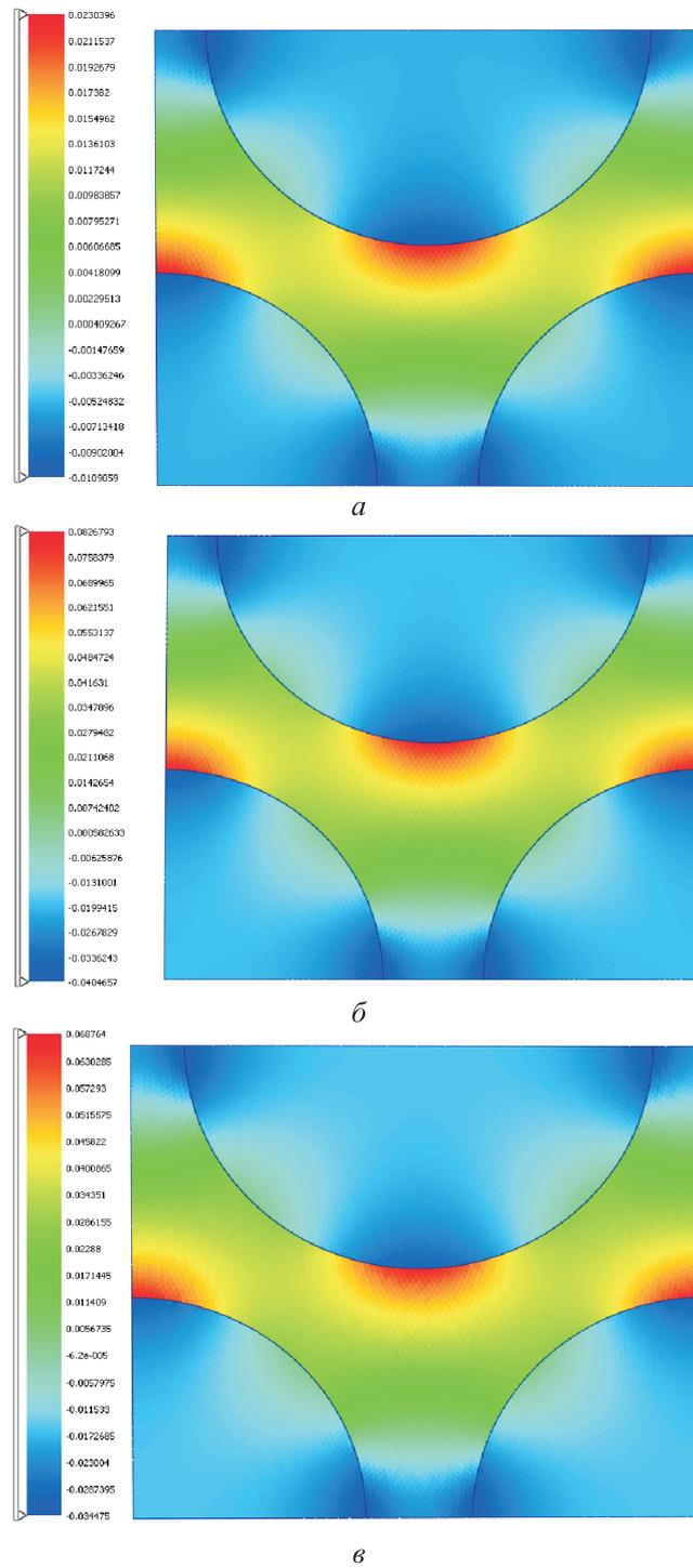
**Рис. 5.** Распределение компоненты  $\text{Re } B_{1313}(\tilde{\omega}, \xi)$  тензора концентрации напряжений  ${}^4\mathbf{B}(\tilde{\omega}, \xi)$  в ЯП однонаправленного композита при частотах 15 (*a*), 100 (*б*), 200 (*в*) Гц
