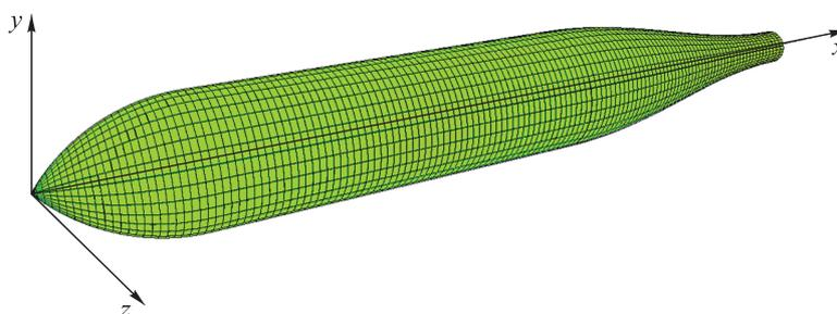
Рис. 5. Конфигурация эквивалентного тела с полубесконечным хвостовым участком
