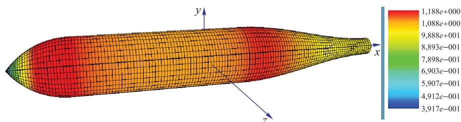
Рис. 6. Распределение безразмерной скорости  $\bar{v} = v/V_\infty$  по поверхности эквивалентного тела с бесконечным хвостовым участком
