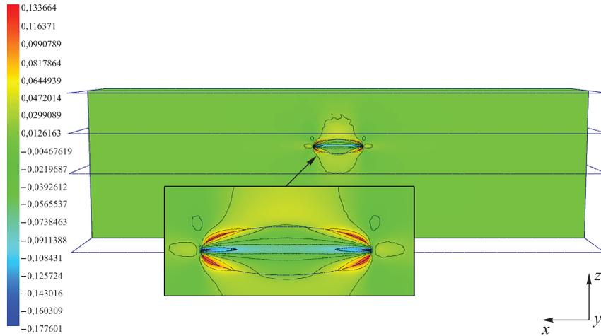
**Рис. 5.** Распределение поля поперечного напряжения  $\hat{\sigma}_{33}^{(1)}$  в локальной задаче  $\hat{L}_1$  для трехслойной композитной пластины с уединенным дефектом
