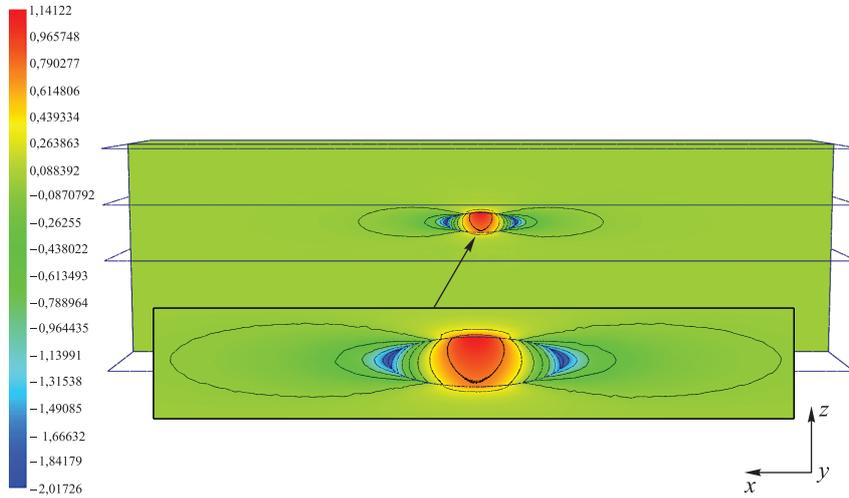
Рис. 3. Распределение поля продольного напряжения  $\hat{\sigma}_{11}^{(1)}$  в локальной задаче  $\hat{L}_1$  для трехслойной композитной пластины с уединенным дефектом
