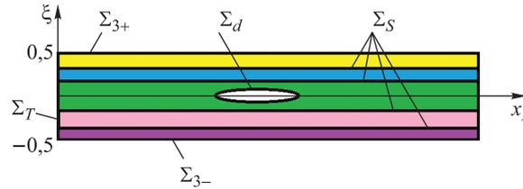
**Рис. 1.** Тонкая многослойная пластина с уединенным дефектом
