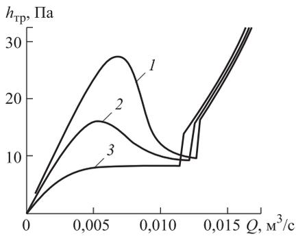
**Рис. 4.** График зависимости гидравлической характеристики  $h_{тр}(Q)$  от коэффициента теплоотдачи  $\alpha$ , Вт/м²К:
