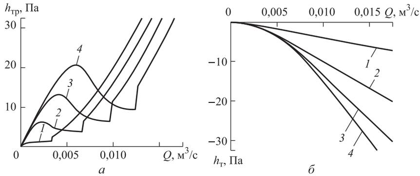
**Рис. 3.** Графики зависимости гидравлических характеристик  $h_{тр}(Q)$  (а) и  $h_t(Q)$  (б) от мощности спирали электронагревателя  $W$ , кВт:
