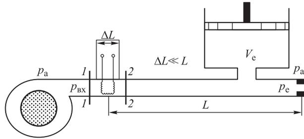
**Рис. 2.** Схема пневмосистемы с нагнетателем и подогревом газа на напорной магистрали:
