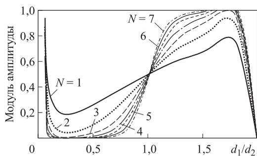
Рис. 10. Расчет при  $\tau = \pi/4$  для отраженной волны
