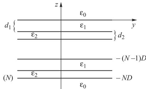
Рис. 1. Одномерный фотонный кристалл с  $N$  слоями
