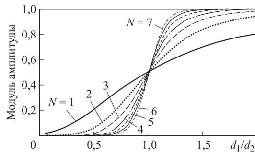
Рис. 14. Расчет при  $\tau = \pi/16$  для отраженной волны
