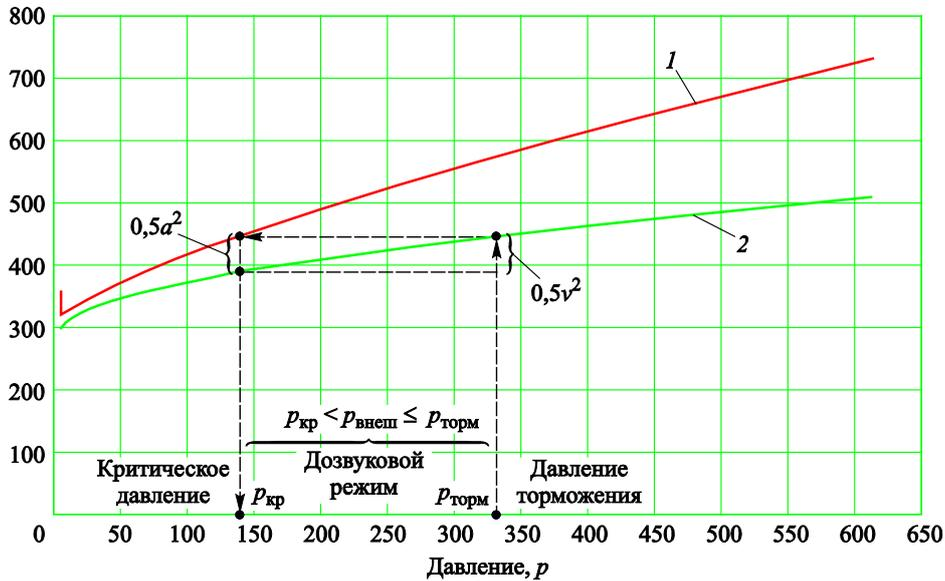
Рис. 6. К определению параметров в выходном сечении БН:
