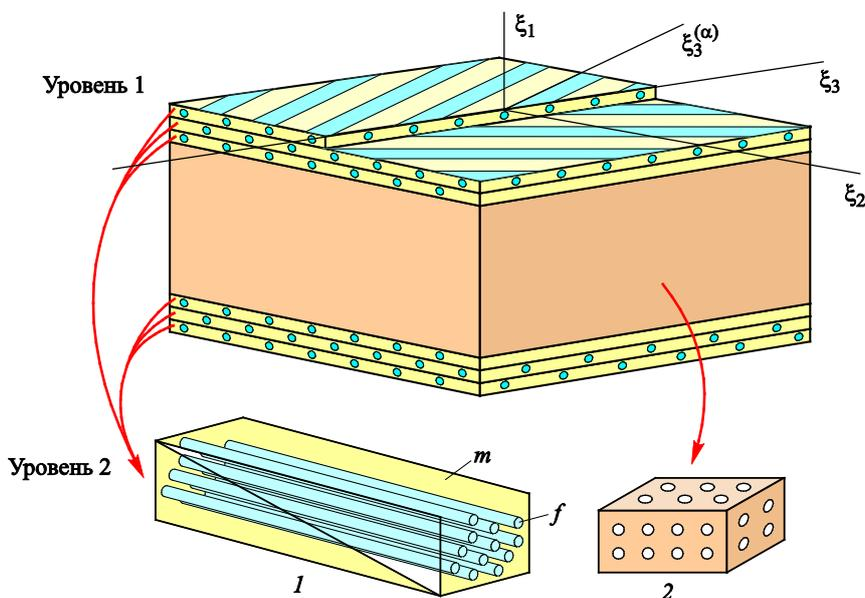
**Рис. 1.** Математическая модель многоуровневой иерархической структуры трехслойной конструкции на основе СВК и пенозаполнителя:
