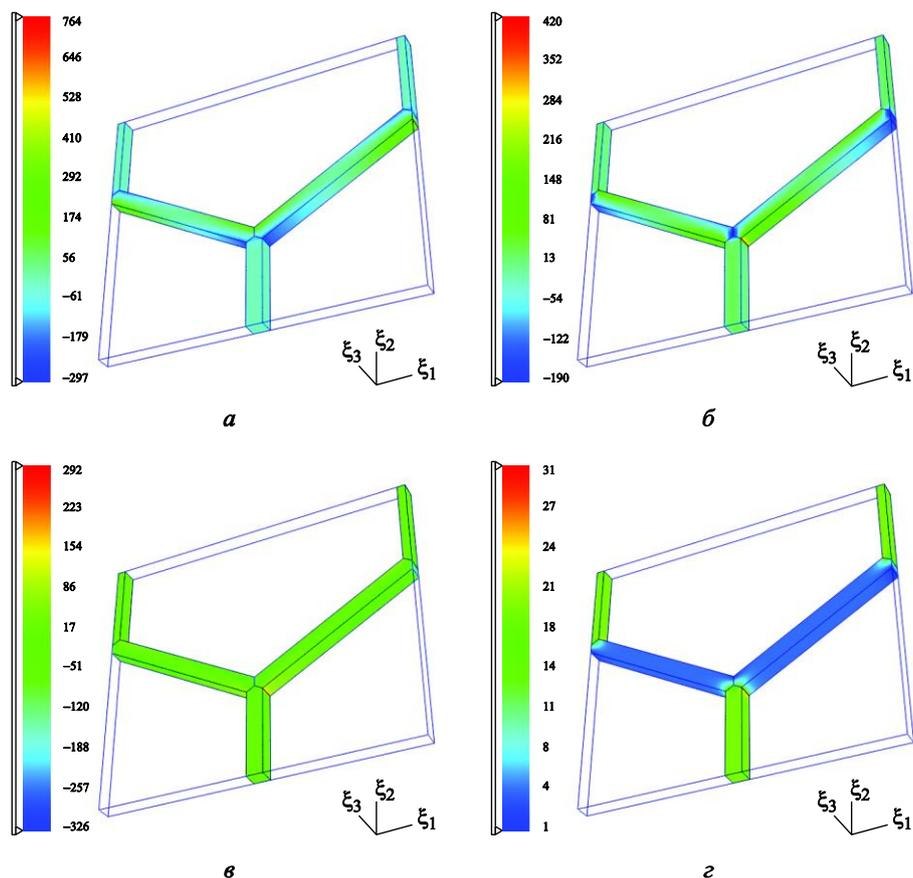
**Рис. 3.** Картины распределения коэффициентов концентрации напряжений  $B_{1111}$  (а),  $B_{1212}$  (б),  $B_{2222}$  (в) и  $B_{22}$  (г) в ЯП конструктивно-ортоотропной пластины из стеклопластикового сотового заполнителя с  $\varphi_s = 0,1$
