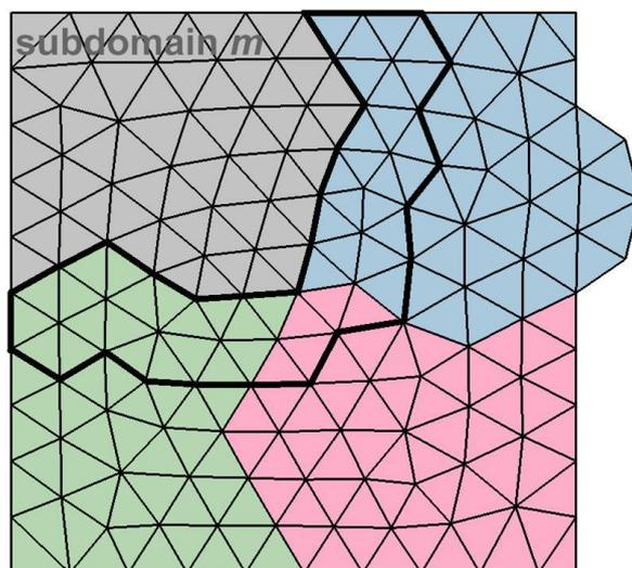
**Рис. 2.** Пример декомпозиции расчетной области на 4 подобласти. Разными цветами обозначены разные подобласти. Серым цветом обозначена подобласть с номером  $m$ . Жирной линией ограничены гало-ячейки подобласти  $m$
