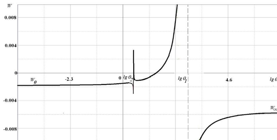
**Рис. 3.** Зависимость максимального прогиба  $W = u_3^{(0)}(0,5)$  двухслойной композитной пластины  $[\pm 45 / \pm 60]$  с проскальзыванием от коэффициента скольжения  $\theta$
