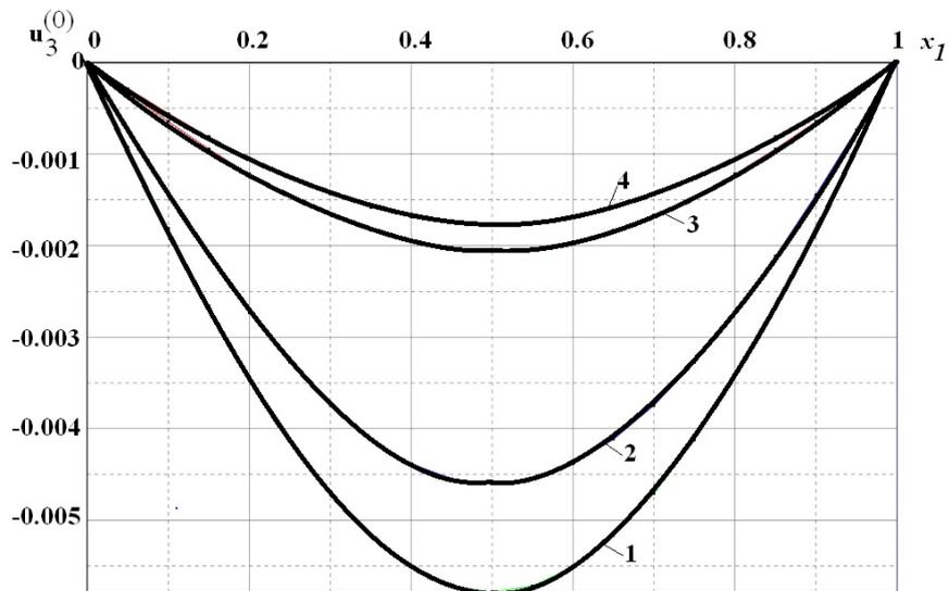
**Рис. 2.** Зависимость прогиба двухслойной композитной пластины  $[\pm 45 / \pm 60]$  с проскальзыванием от продольной координаты  $x_1$  для разных значений относительной толщины слоев  $h_1$ :
